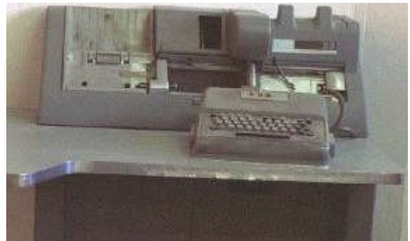
Perfuradora de Cartões Hollerith. Até não muito tempo atrás (em torno de 1980), quando a utilização de mainframes era comum, a forma de se entrar dados no computador era através de cartões perfurados numa máquina como essa.
